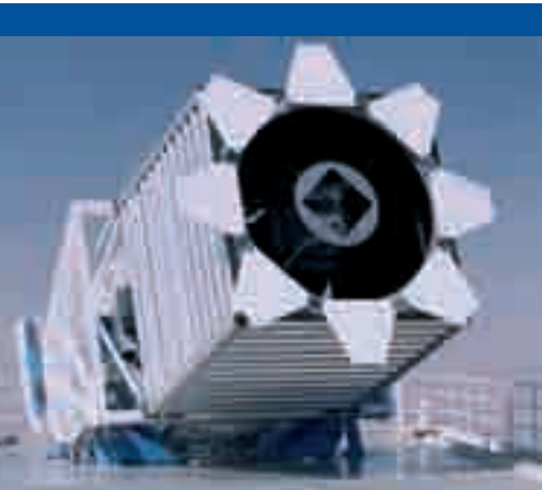
Figura 47.4. SDSS. El proyecto de cartografiado del cielo SDSS ( Sloan Digital Sky Survey ) cuenta con un telescopio de 2,5 metros de apertura.
